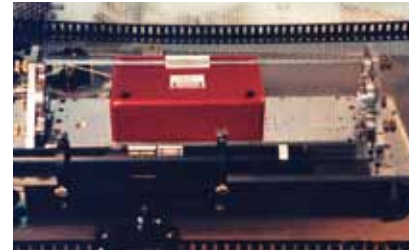
初めて発振に成功したフラッシュランプ励起型 2\mu\text{m} レーザー
