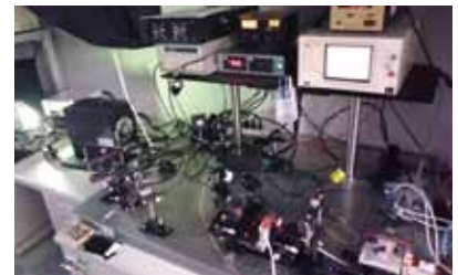
2\mu\text{m} レーザーを用いた \text{CO}_2 リサイクル実験
